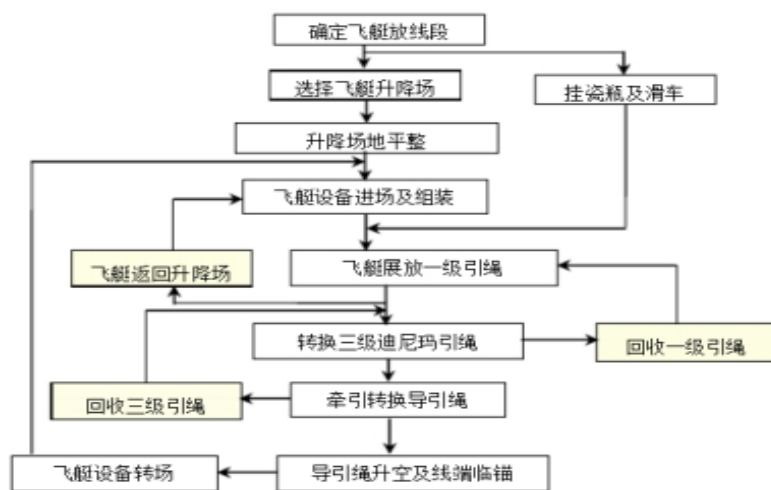
图 2-9 飞艇放线施工流程图
