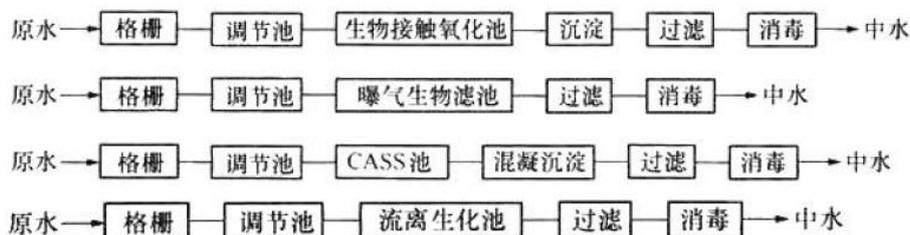
图 4-3 污水处理站推荐的工艺流程图
