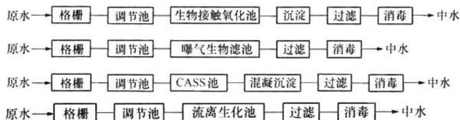
图 4-3 污水处理站推荐的工艺流程图
